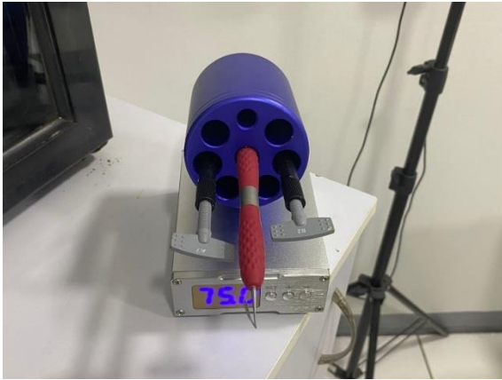
Precalentamiento de espátulas y resinas a 75 grados F.
