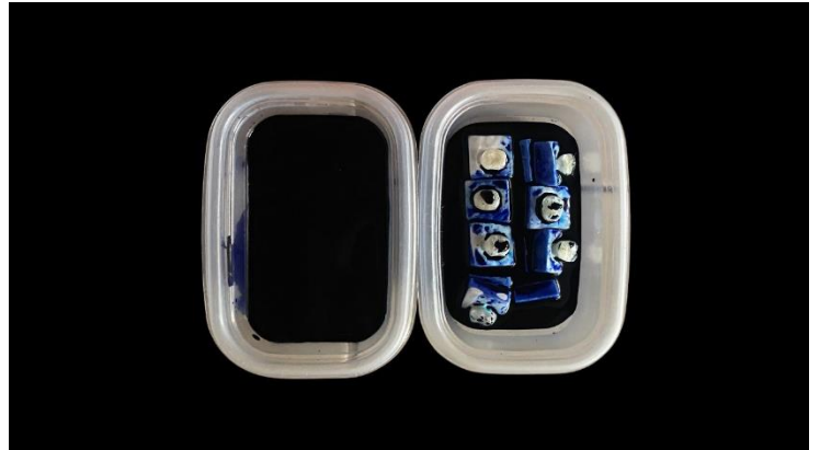
Colocación de modelos 3d en azul de metileno, se colocó líquido hasta que quedaran cubiertos
