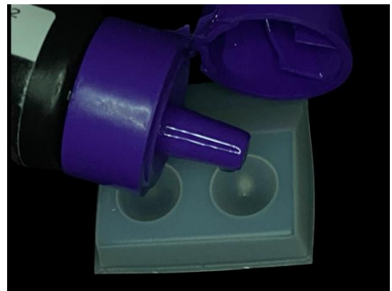
Colocación de adhesivo, este no se polimerizo.
