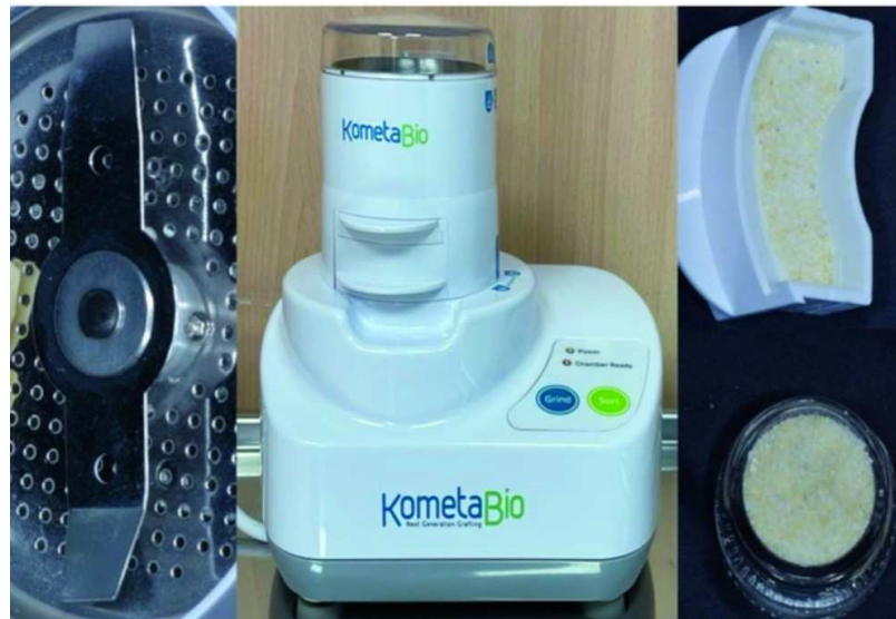
Figura 20. Muestra las cuchillas o aspas del molino, la bandeja o receptáculo donde se deposita el hueso una vez triturado. Imágenes de referencia tomadas la empresa distribuidora.
