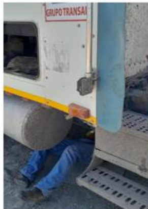
Riesgo de atropellamiento de personas que hacen reparaciones imprevistas
