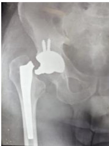
Figura 2. Radiografía AP de la cadera derecha, se observa una prótesis total de cadera no cementada y fatiga del vástago femoral a nivel del cuello. Dr. Roberto Montiel
