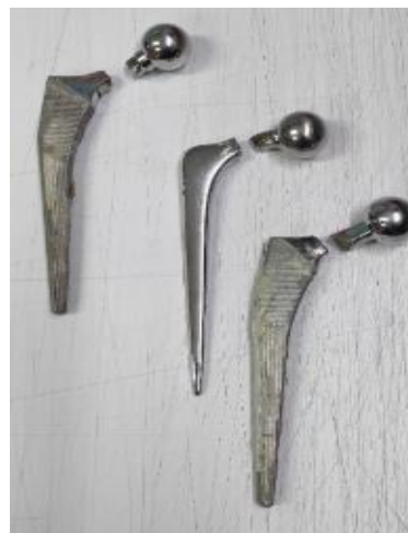
Figura 3. Vástagos femorales fatigados a nivel de la base del cuello. Dr. Roberto Montiel
